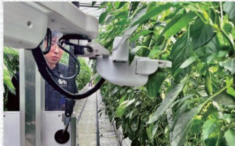
農作業用レールの上を自走しながらピーマンを収穫するロボット
