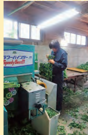
フラワーバインダーによる葉取り・調整・結束作業
