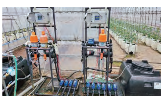
左が2液式給水装置。右の1液式と比べて溶解タンクと液肥混入器が増えている。導入コストはその分高い。
