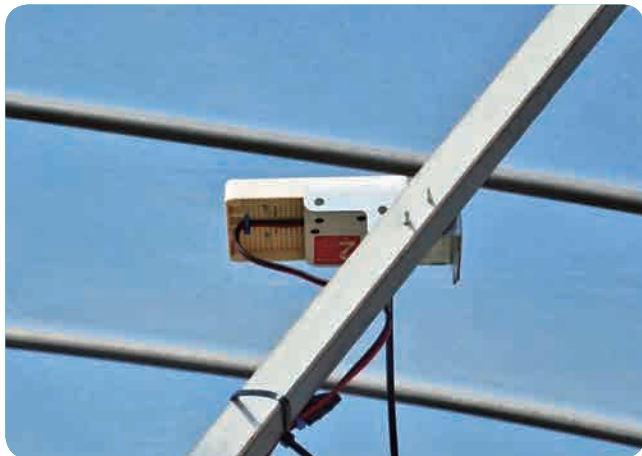
日射を計測する装置
